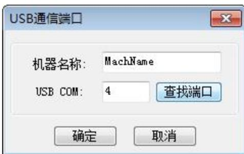
机器名可以任取，输入机器名称后，点击查找端口，查找端口成功后点击确定完成修改。
