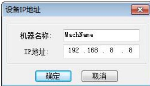
设置机器名称，可以任取名，输入板卡控制面板中的 IP 地址，点击确定完成软件修改。
